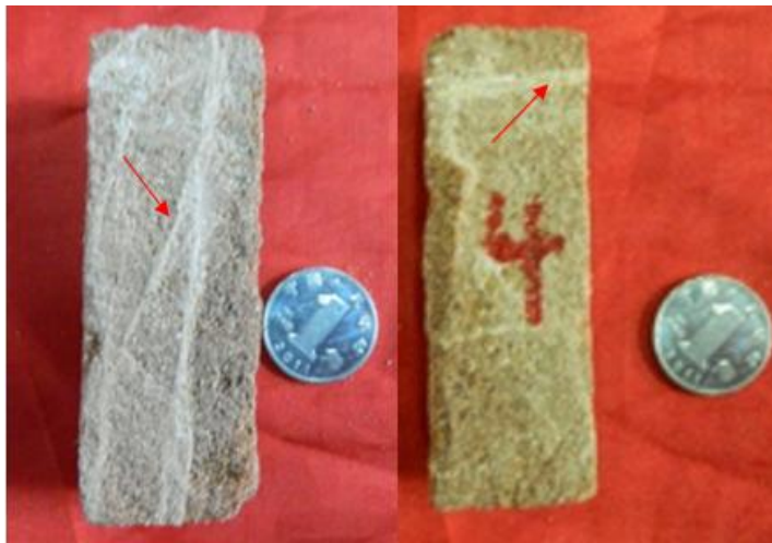
红色箭头所指为变形带，左为样品的正面，右为样品的反面
